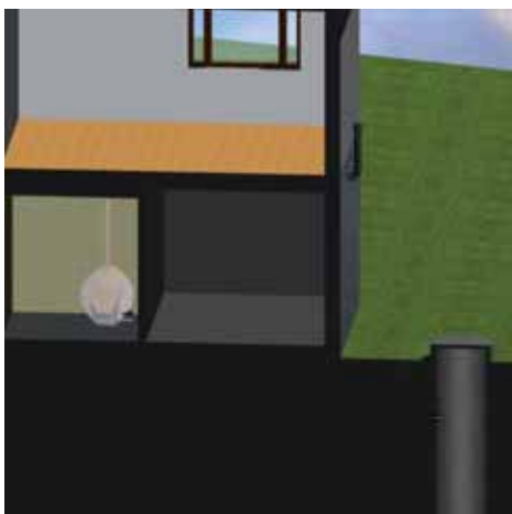
Sanita a seco com saída de ar e armazenamento da urina no exterior.
