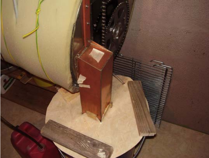
Kuva 3 Säiliön päässä on ämpäri, johon kompostoitunut käymäläjäte tippuu.
